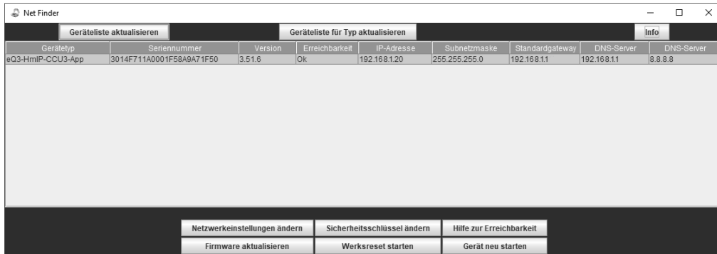
Abbildung 3.16 NetFinder zur Ermittlung der IP-Adresse der CCU
