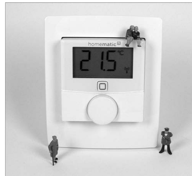
Abbildung 27.9 Raumregler im Tischgehäuse für die Handbedienung
